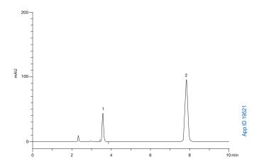
**Column:** Luna 5 µm C8(2) **Dimensions:** 250 x 4.6 mm **Part No.:** 00G-4249-E0
